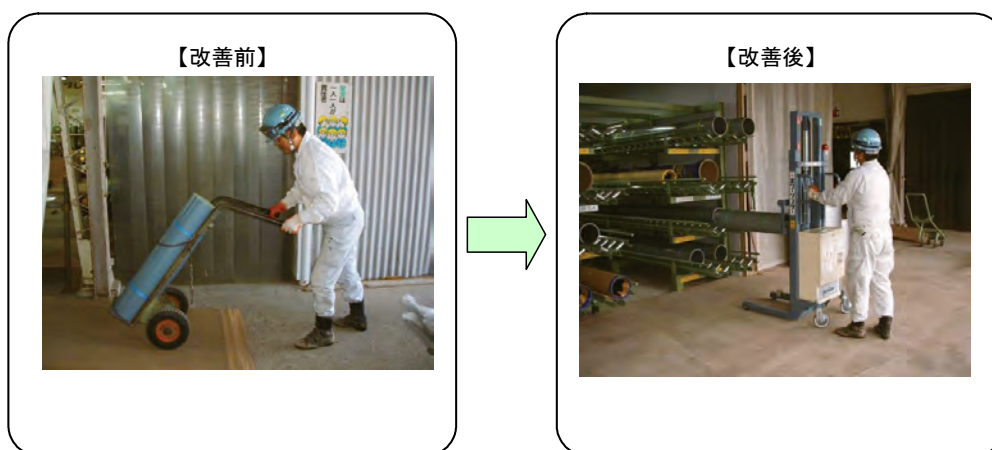
写真 3 板金運搬・供給作業支援装置の改善前・改善後の写真
