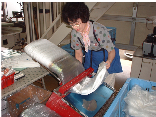
写真-6b（包装工程）の自動包装機での作業の様子（右）
