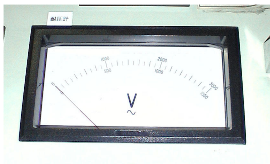
写真 14 旧検査器のメーター (文字高 2.5mm)
