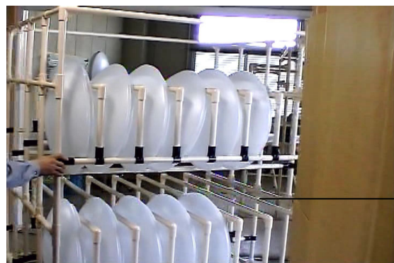
写真7 照明カバー搬送ラック
