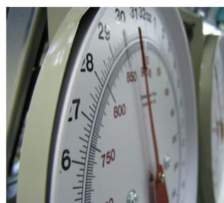
図IV. 2. 9 目盛板と指針隙間を平均化
