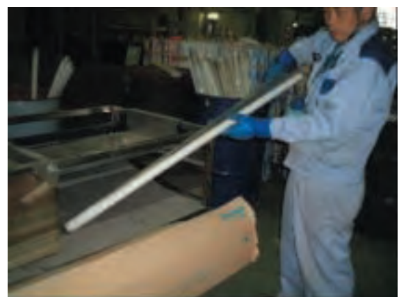
写真12 フィルム除去作業支援機器におけるフィルム剥ぎ取り作業
