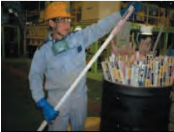
写真4 蛍光灯の単品鞘抜き作業
