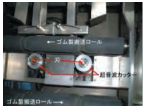
写真11 フィルム除去作業支援機器の超音波カッター部（上方から床方向の展望）
