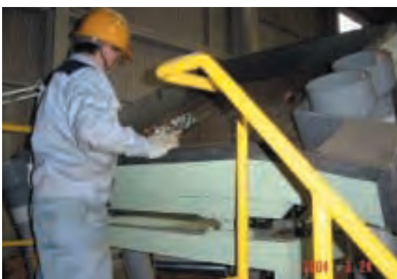
写真8 傾斜テーブルによる手選別作業
