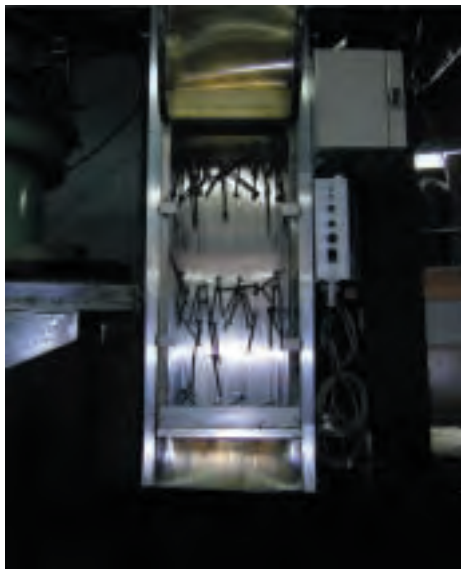
写真11 磁気により上方に搬送される資材
