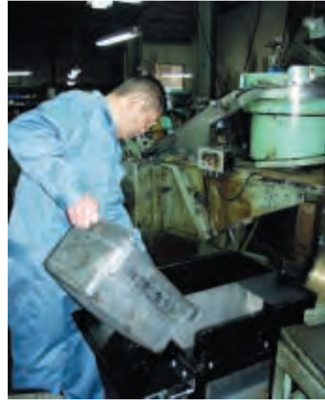
写真10 資材をホッパーに投入する作業
