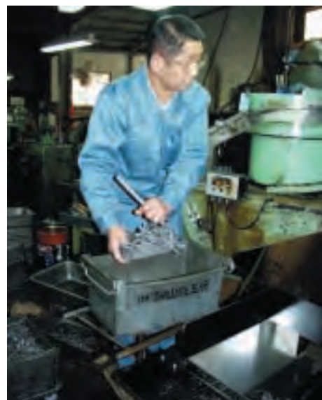
写真6 熊手で掬った資材をパーツフィーダに移す作業
