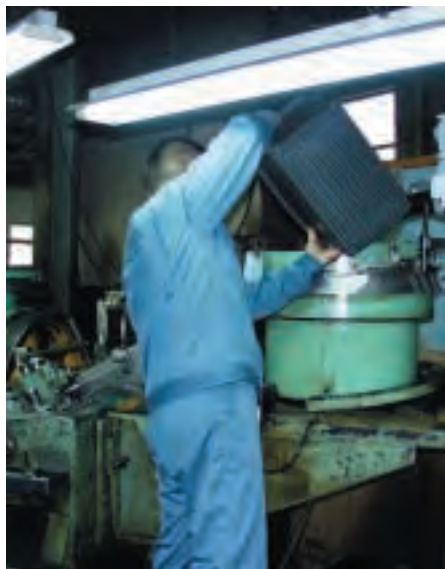
写真7 箱から直接パーツフィーダに資材を投入する作業
