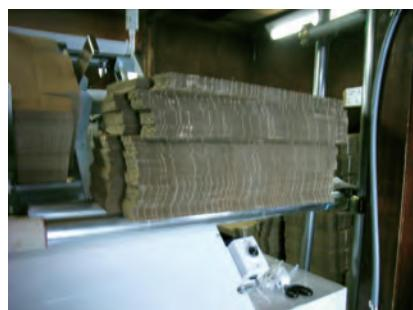
品目別作業指示の通り原紙を取り出し、一部を供給にセットする。
