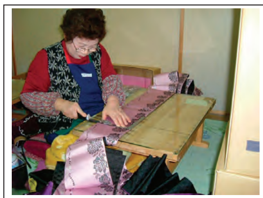
熱切断作業状況
