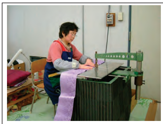
椅子式超音波切断作業
