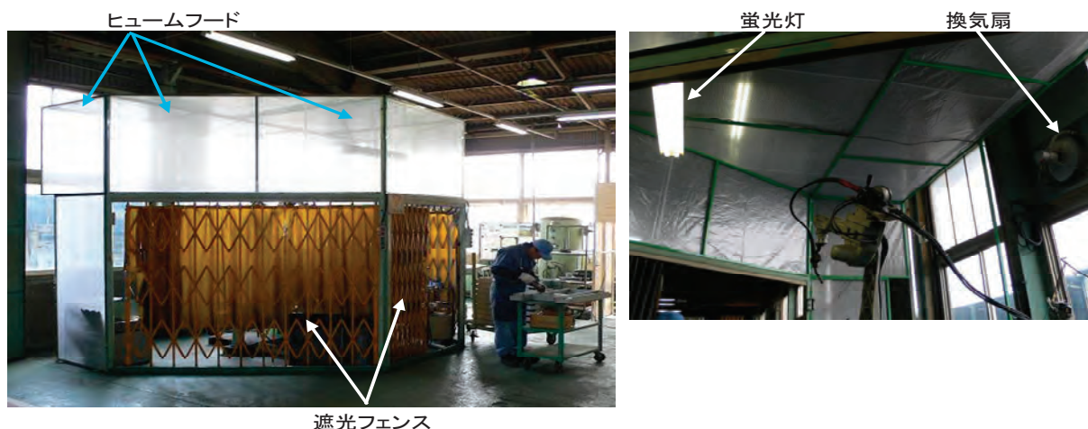
図表Ⅲ-21 改善後のロボット溶接機Aヒュームフード
