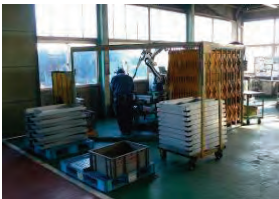
図表Ⅲ-18 ロボット溶接機Aの現状
