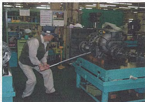
写真2、3 ケース合体時のボルト締め付け作業
