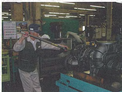
写真2、3 ケース合体時のボルト締め付け作業
