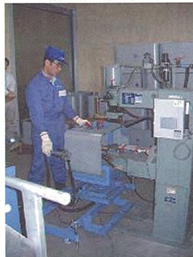
写真8 自動昇降機能付きスポット溶接治工具
