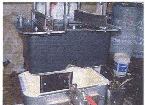
写真18 テフロン加工を行った 型枠一体化タイプ
