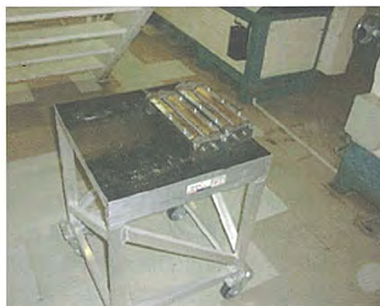
改善後：切刃保管・清掃用作業台の製作
