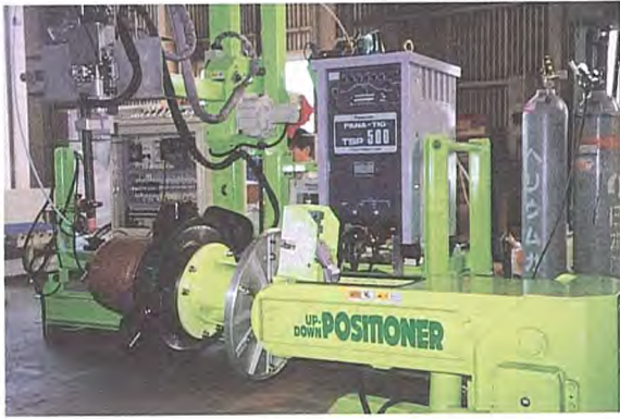
写真6 羽口先端硬化肉盛溶接機
