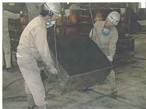
写真2 鋳型反転作業
