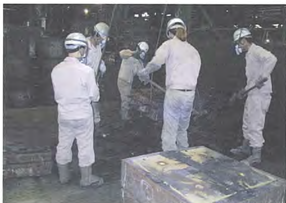
写真 4 鋳枠解体の状況
