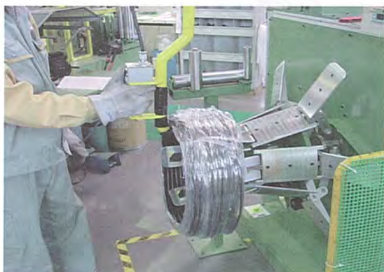
写真1.2 タバ取り出し作業
