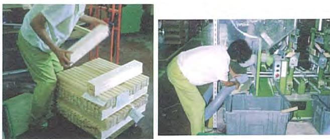
写真6 両留め切り作業（改善前）
