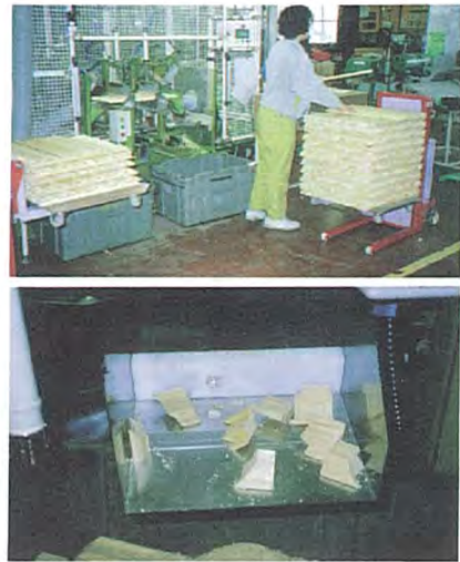
写真7 両留め切り作業（改善後）
