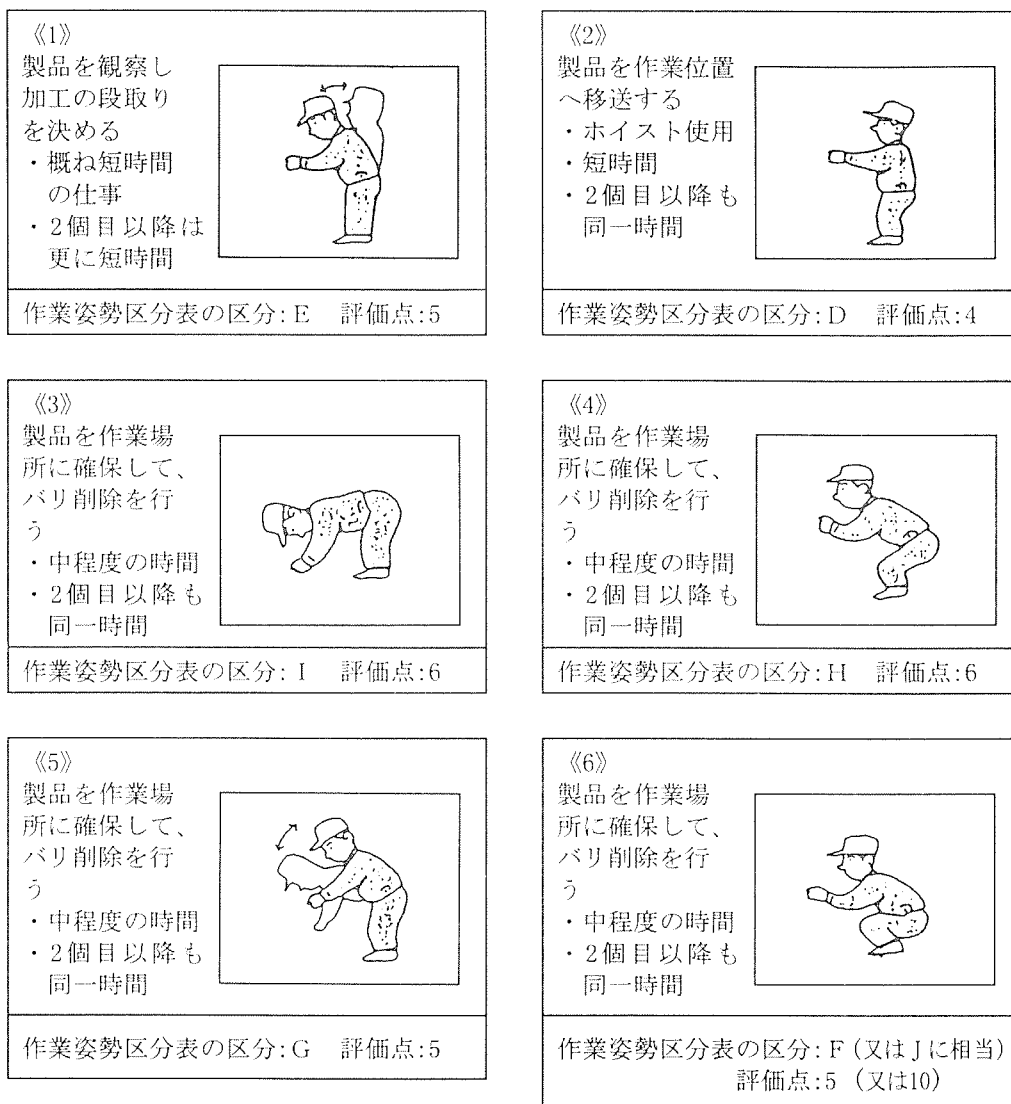
図2 従来作業の姿勢区分と負担度評価 以下のような作業姿勢及び動作が頻繁に観察される
