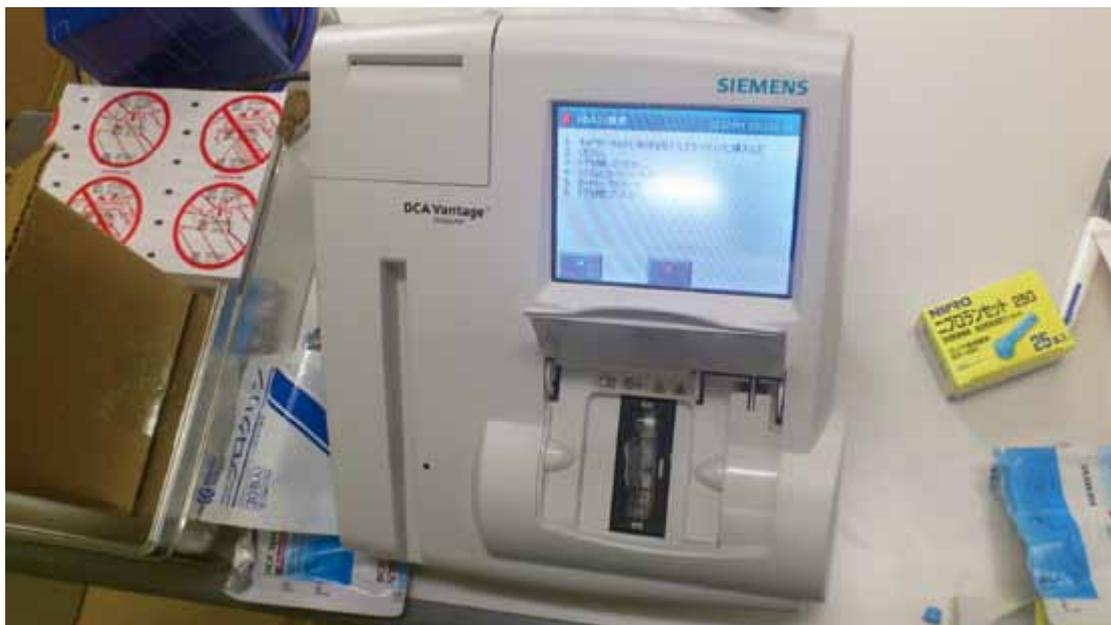
写真－7 DCA Vantage にカートリッジをセットし、測定開始
