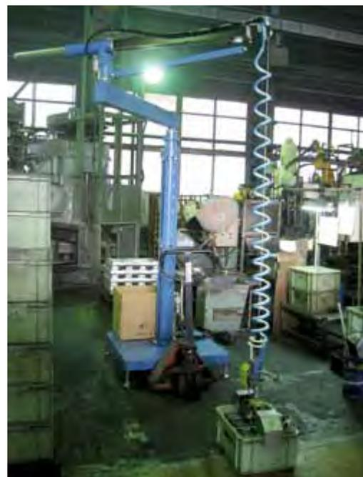
写真3 バケット運搬作業支援機器
