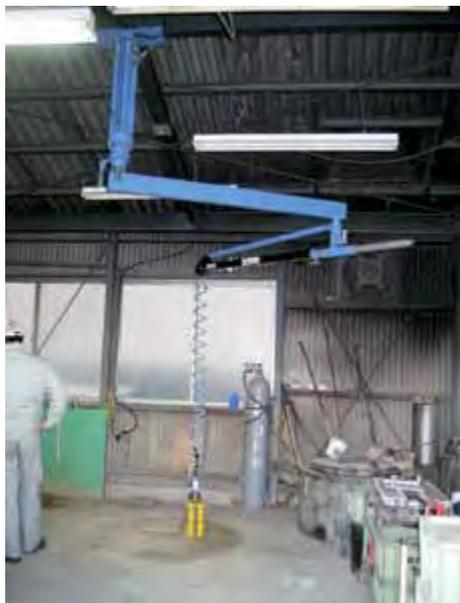
写真 6 砂型運搬作業支援機器
