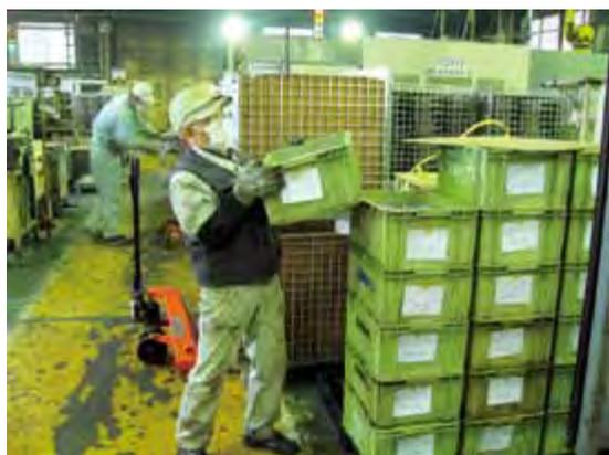
写真2 バケット運搬作業(改善前)
