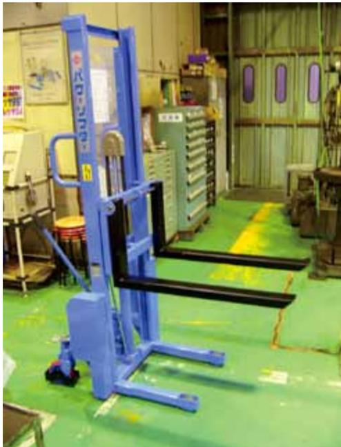
写真9 治具運搬作業支援機器
