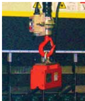
電磁石の着脱部位
