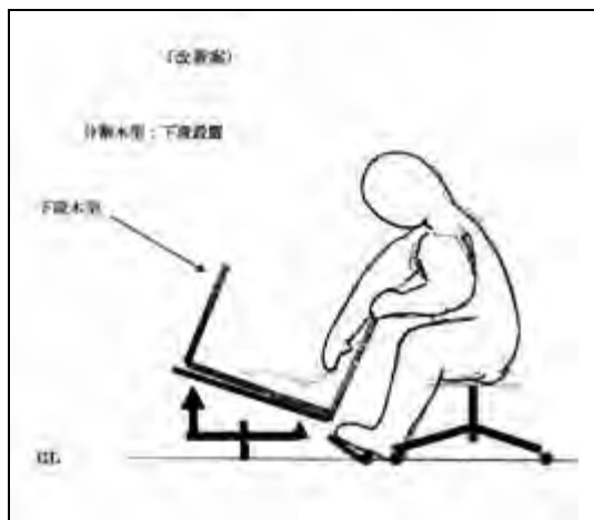
図-4 改善後のイメージ①：分割木型の下段部の作業
