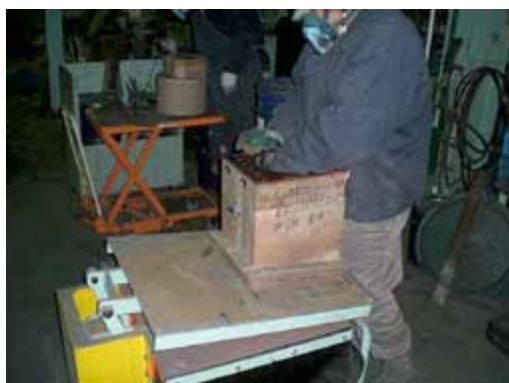
写真-30 改善後 (分割木型下段部の作業)
