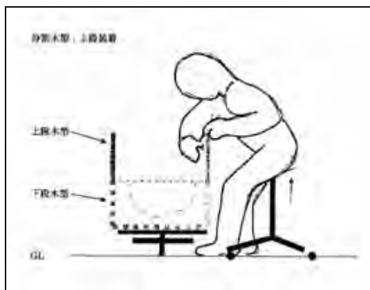
図-5 改善後のイメージ②：分割木型の上段部の作業
