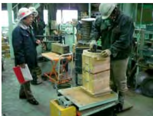
写真-31 改善後 分割木型上段部の作業
