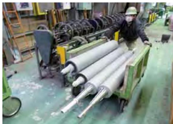
写真7 鉄芯運搬作業
