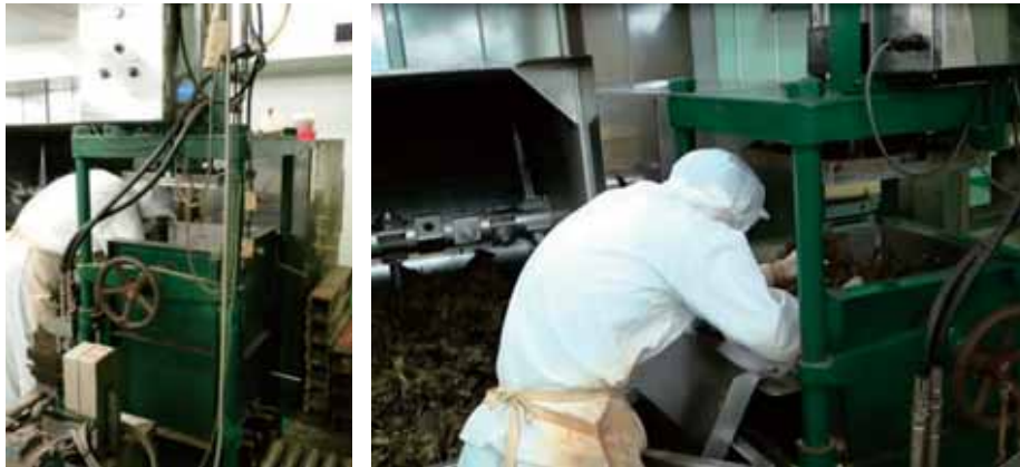
【改善前】仮プレス機の中に昆布を入れている様子
