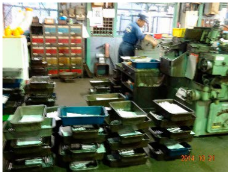
写真 22～24 切断されたタップ 素材、切削機による加工内で待機 中のタップとそのケース(重量扱 いの源)
