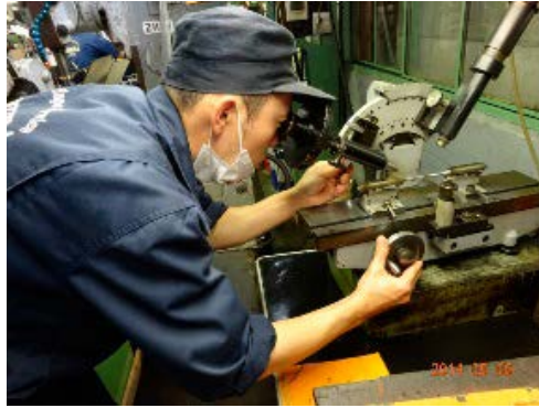
写真 29 機器開発の作業、溝角度測定器とその作業
