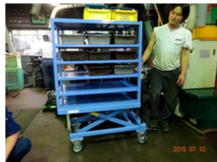
写真34 集積と台車を統合した支援機器
