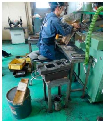
写真 15～16 床のタップ・ケースを利用した作業台の作業工夫例
