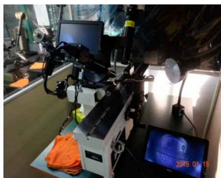
写真 37 新溝角度測定装置
