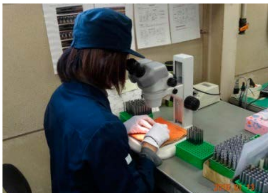
写真 14 最終検査作業
