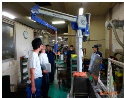
写真 45 バランスーを設置した作業場
