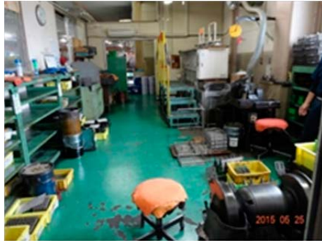
写真 39～40 改善前の洗浄現場の全景、洗浄作業時は階段昇降が付随 (奥投入口より順次浸漬)
