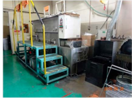
写真 39～40 改善前の洗浄現場の全景、洗浄作業時は階段昇降が付随 (奥投入口より順次浸漬)
