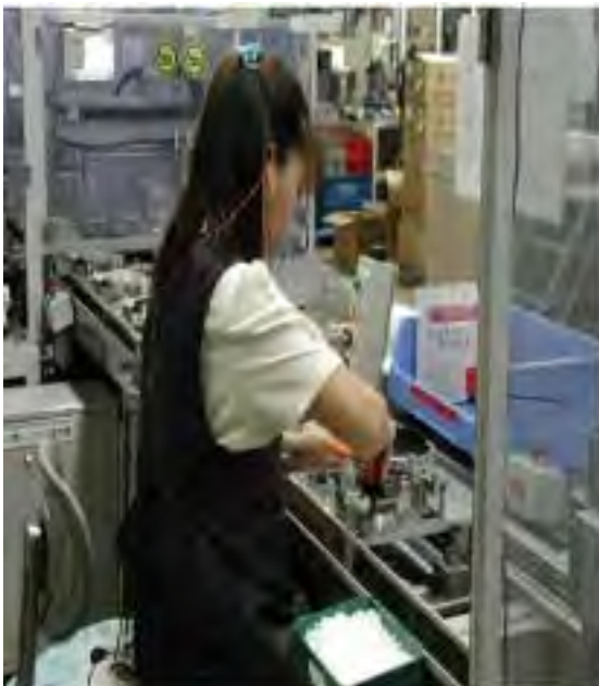
Fig.3.33 リール工程作業風景 (ブラシA・B/コード押し込みセット)
