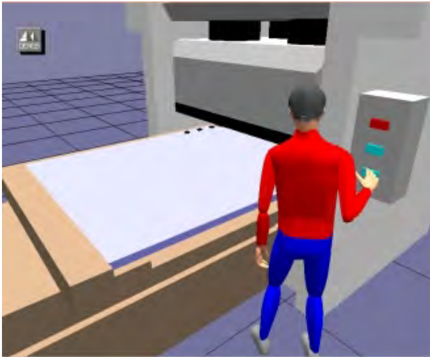
図 2-3-23 動画による支援機器 —自動送り装置付き油圧プレスリベット
