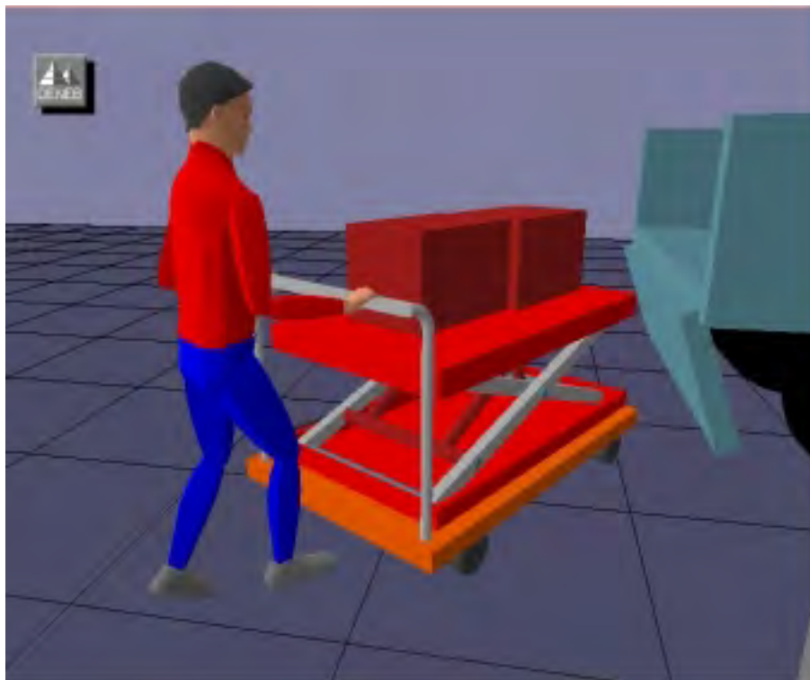
図 2-3-20 動画による支援機器 —テーブルリフターを載せた台車
