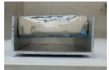
図3 ネオジウム磁石による飛杼の浮上（約10mm）
