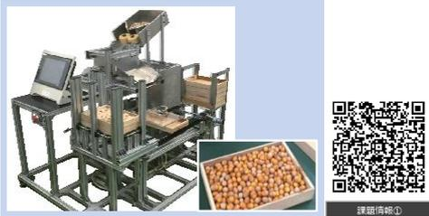
銀杏の出荷作業の全行程（殻割り、品質判定、箱詰め）を自動化。手作業では時間と労力を要する箱詰め作業を自動化し、作業時間を短縮しました。依頼元企業の要求を超える性能を実現しました。
