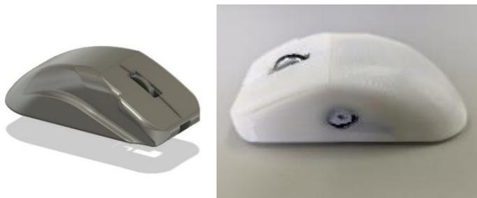
図1 デバイスのモデル（左）と筐体（右）
