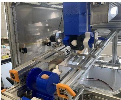
図3 煮玉子外観検査及び搬入装置
