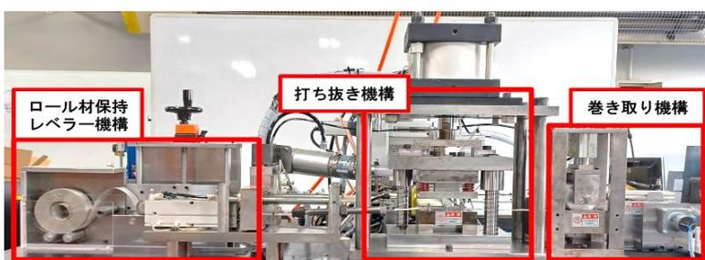
図2 供給・打ち抜き加工部
