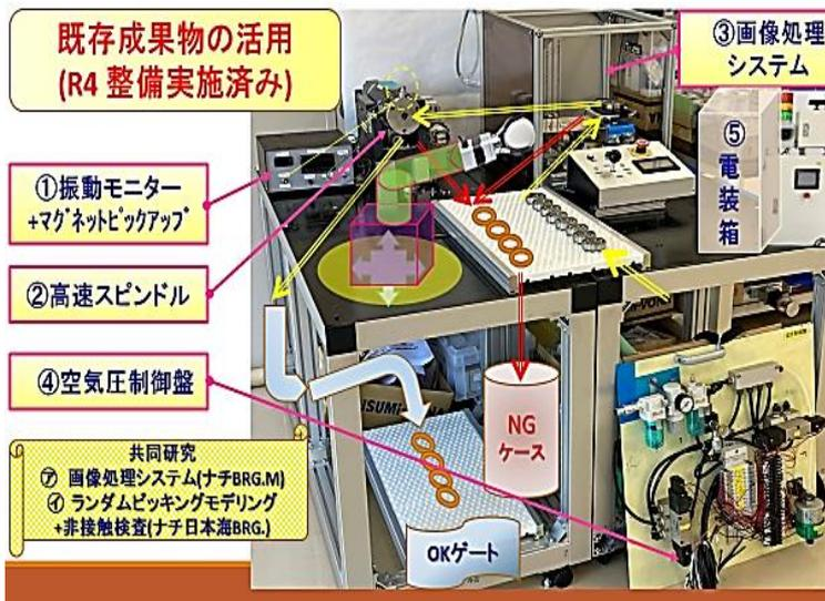
図1 軸受検査装置の全容
