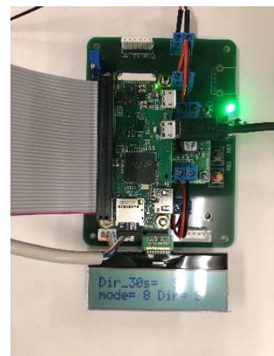
図3 シングルボードコンピュータ (制御装置)
