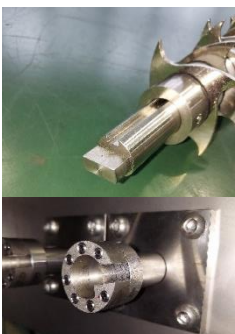
図4 ワンタッチ軸（上） と軸受け側（下）
