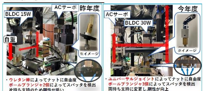
検査①・② ナット検査部
