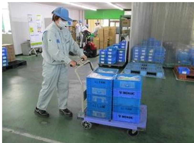
出荷作業において、平均150kgの製品箱を乗せた台車を自力で運搬しており、作業者への負担が大きかったが、**電動台車を導入**することで、**運搬作業の負担軽減**を図った。
