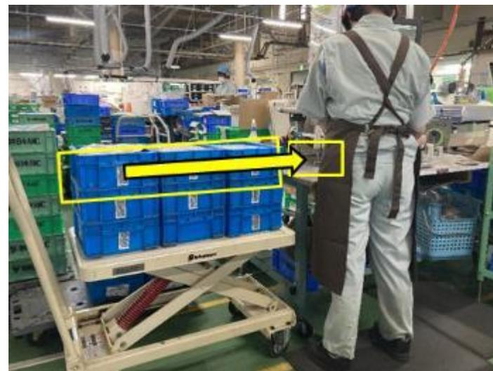
出荷工程において、製品箱を台車から作業台へ移動する際に、台車と作業台の高低差が大きく、作業者の腰への負担が大きかったが、**レベラー台車を導入**し、高低差を最小限にすることで、**腰への負担軽減**を図った。
