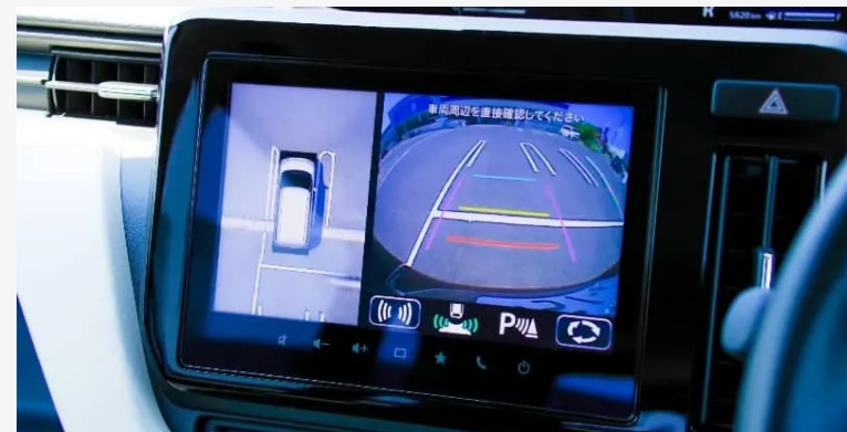
全車両に装備されたバックモニターシステム
