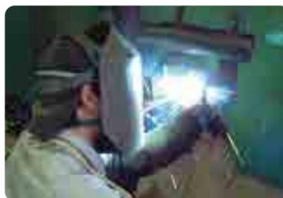
炭酸ガスアーク溶接に関する技能(下向き・立向き・すみ肉溶接)及び関連知識を習得します。
