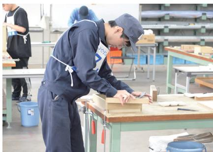
切断済みの材料から、ノコギリ、ノミ、カンナなどの手工具を使い、図面の指示に従い、木箱を作る競技です。加工精度や仕口（2つ以上の部材を組み合わせて接合する方法）などの出来栄え、そして作業時間がポイントとなります。
