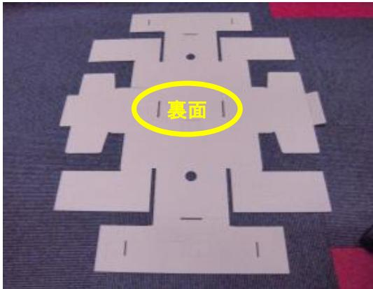
※罫線(折れ線)が見える方が裏面になります
