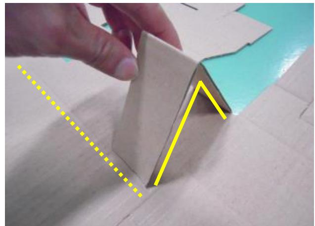
4. 袖部分を立ち上げ、3で折った三角部分に巻き付けるように折り込む。
