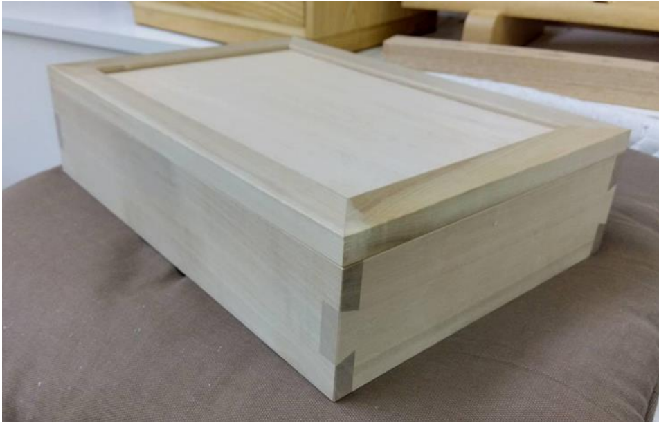
三枚蟻組接ぎ（※本大会ではふたの取り付けは行いません。）
