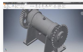
課題「動力伝達装置」2D計画図と3Dパーツアセンブリデータ
