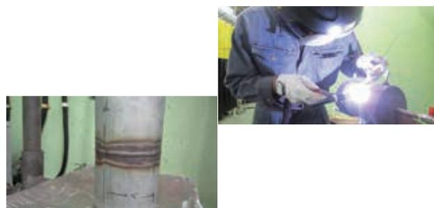
★TIG溶接によるアルミニウム合金の溶接施工を行います。
