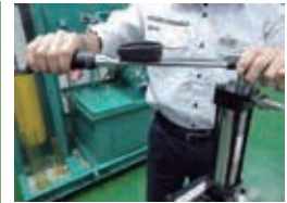
トルクレンチを用いた締付管理実習
